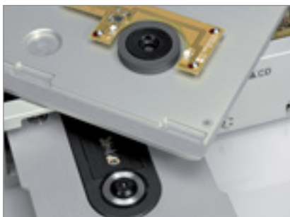
Sensoren im Deckel verhindern, dass der Player ohne Disc-Clamp startet
