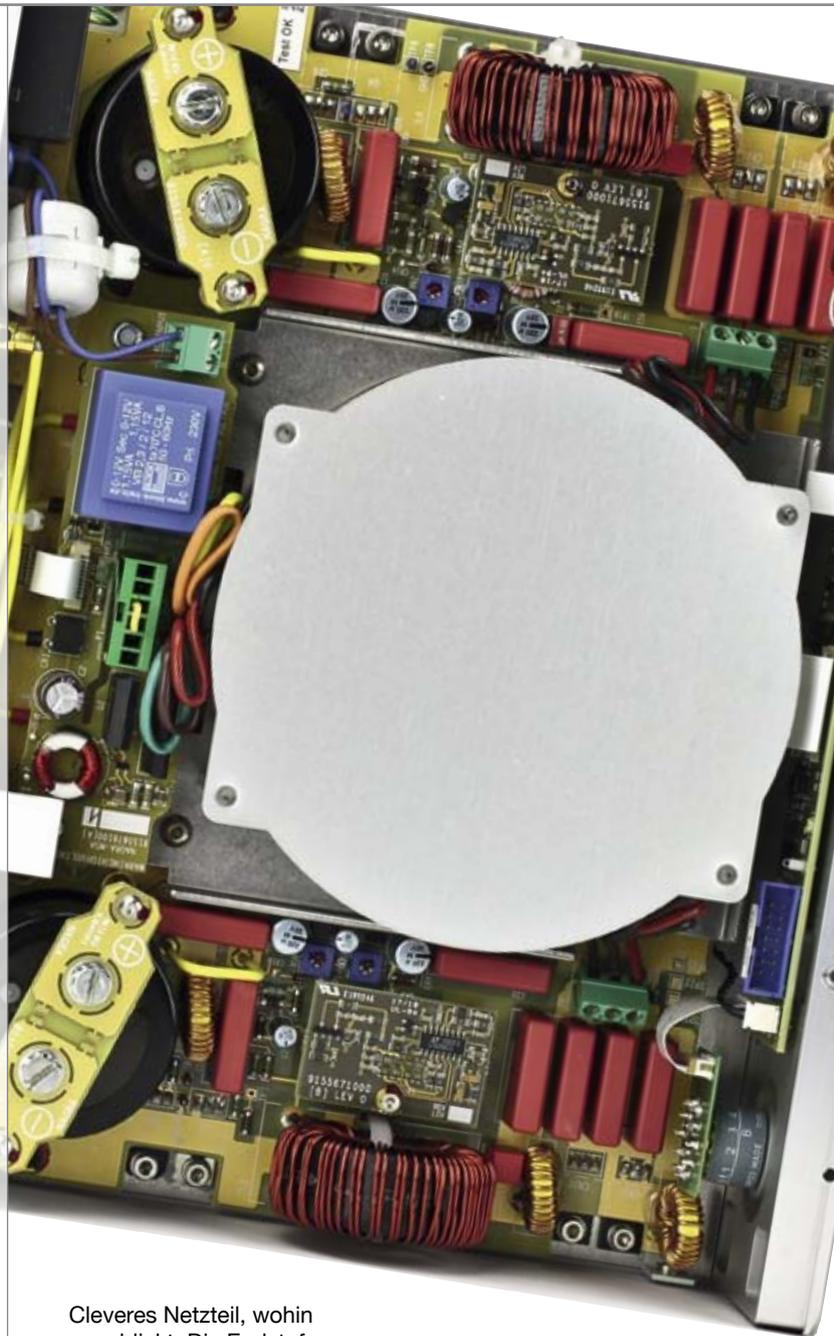
Cleveres Netzteil, wohin man blickt. Die Endstufe steckt unter dem Trafo
