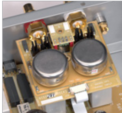
Der VPS wird mit den Jumpers hinter den Übertragern konfiguriert
