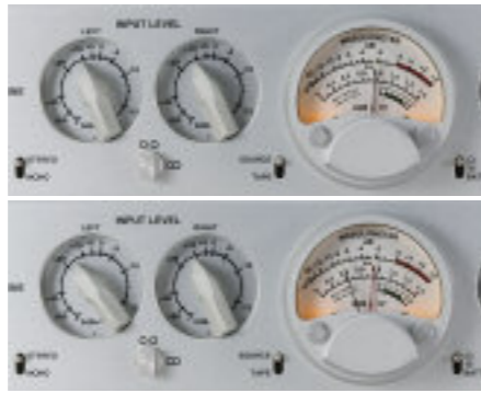
Bei identischer Position der Vorpegelsteller und einem Monosignal stehen die Zeiger vom „Modulometer“ des PL-P exakt übereinander (o.). Dass es tatsächlich zwei Nadeln sind, zeigt das untere Foto
