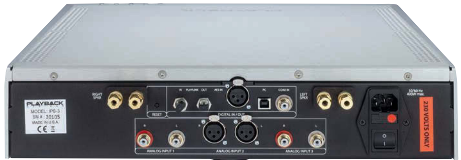
Je drei digitale und analoge Eingänge plus spezielle Schnittstellen für andere Digitalgeräte des Herstellers und ein Paar Boxenklemmen pro Kanal – der IPS-3 outet sich als Purist
