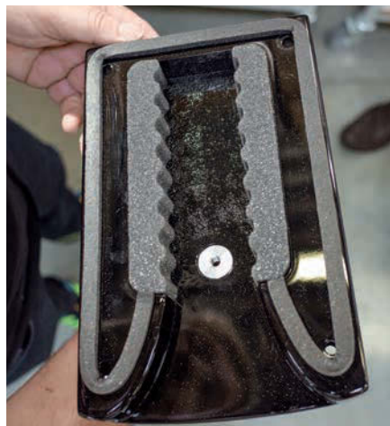
Einfach und wirkungsvoll: zur Geräuschvermeidung bedämpfter Reflexkanal
