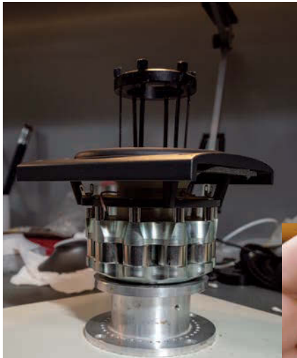
Oben: der von Hand montierte Magnetantrieb eines Chassis
