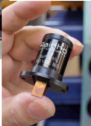
SMD-Kondensator, den Raidho sich speziell anfertigen lässt
