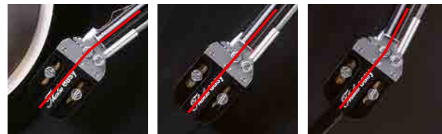
Die roten Linien verdeutlichen das Prinzip: Auf dem Weg über die Platte wird der Tonabnehmer gegenüber dem Hauptrohr so im Winkel verstellt, dass er stets praktisch gerade zur Rille steht. So bleibt der bei Drehtonarmen eigentlich unvermeidbare Spurfelhwinkel zu jeder Zeit minimal. Außen steht der Abtaster leicht eingewinkelt (r.), in der Mitte gerade (M.) und innen etwas nach außen geneigt (l.).
