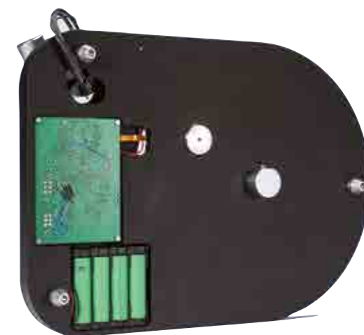
Hinter einer Abdeckplatte im Boden verbergen sich die vier Akkus und die Steuerelektronik.
