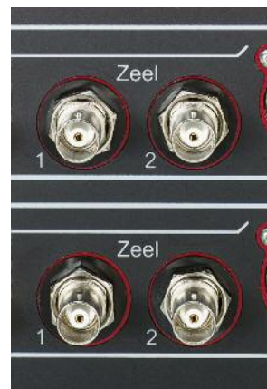
Die BNC-Eingangsbuchsen sind hier mit Zeel beschriftet, ein Quellgerät bieten die Schweizer aber nicht an. Die BNC-Ausgangsbuchsen sind zum Anschluss der Endstufe NHB-108 gedacht
