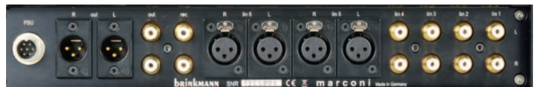
Vor- und Endstufe sollten in diesem Fall zugunsten des Geräuschspannungsabstands ausschließlich symmetrisch verbunden werden. Ganz links ist der Anschluss des externen Netzteils zu sehen.
