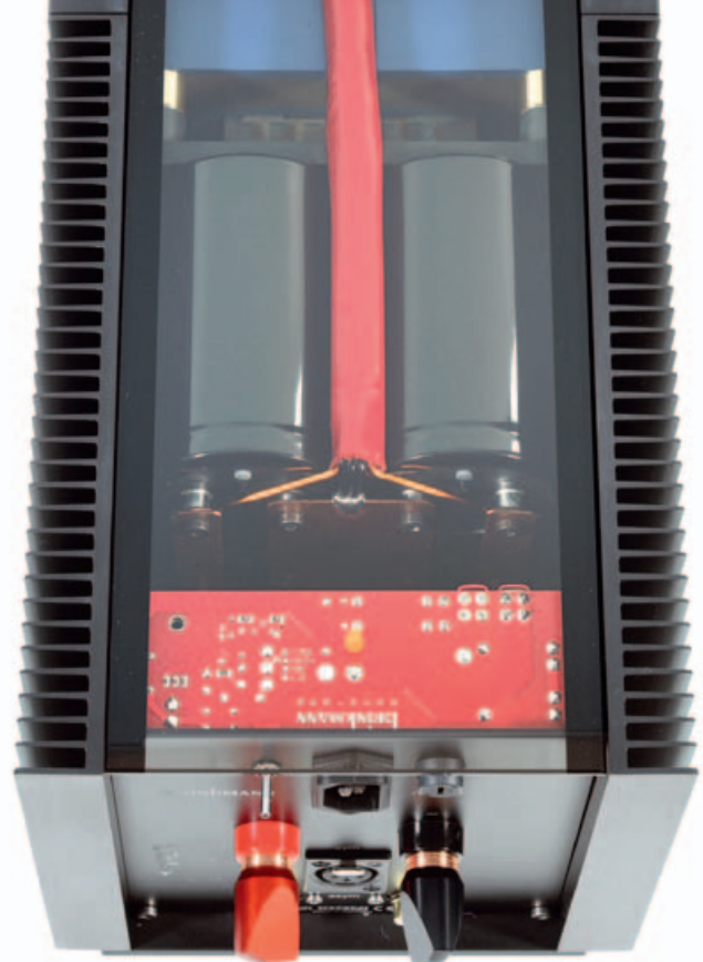
Abgesehen vom symmetrischen Eingang bieten die Monos zwei Cinch-Anschlüsse: invertierend und nicht invertierend.
