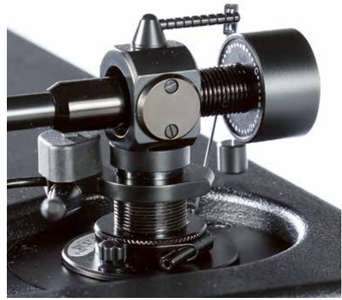
Über eine flache Rändelschraube lässt sich feinfühlig die Tonarmhöhe anpassen. Wenn's passt, die Arretierung per Inbus festziehen.
