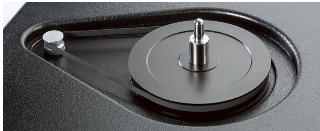
Der Synchronmotor mit Metall-Pulley treibt über einen kurzen Flachriemen den Subteller an. Beide Teile ins Kunstharz-Chassis zu versenken half dabei, das Model 6 modisch flach zu halten.
