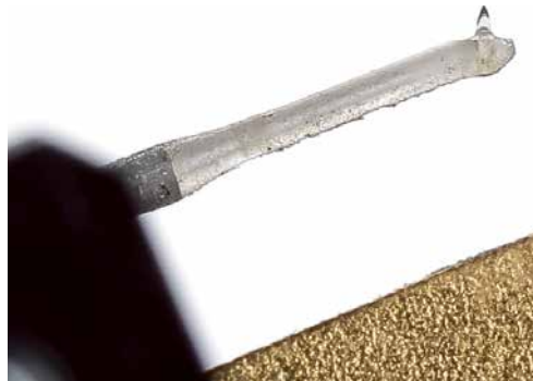
Der Saphirnadelträger sitzt in einem Aluminiumröhrchen. Sein Diamant ist fest in ein per Laser geschnittenes Loch geklebt (siehe Skizze links).
